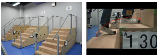
（写真2）階段の蹴上げ寸法に関する実験
