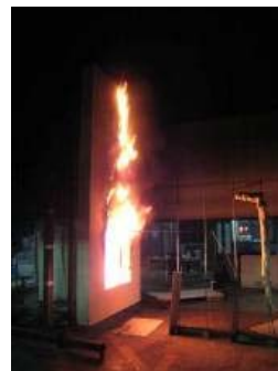
図 6 外断熱工法試験体の燃焼性状
