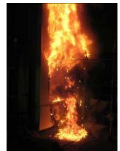
図 7 EPS 試験体の燃焼性状
