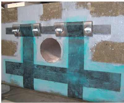
図10 梁のあと抜き貫通孔補強の方法
