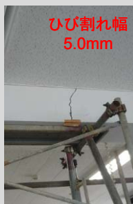
9構面大梁端部及び中央部の曲げひび割れ(中央たわみ128mm)*
