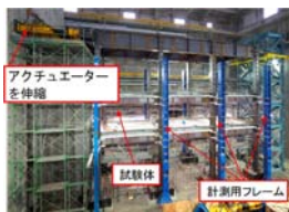
鉄骨造3層実大架構試験体の多数回繰り返し載荷実験
