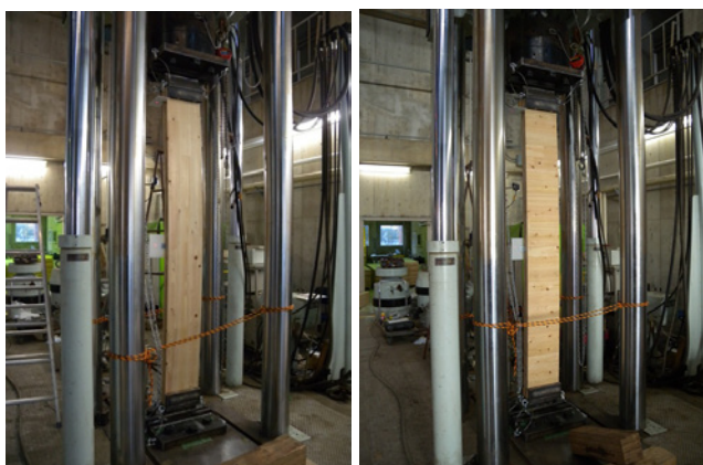
写真8 座屈試験の様子 (解説) 左：強軸方向加力、右：弱軸方向加力
