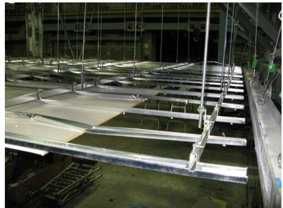
写真 6 面材 (せっこうボード) の落下 (実験結果)
