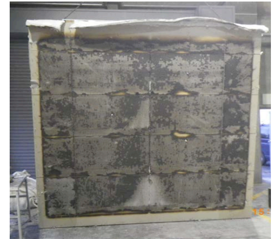
写真10(2)木造1時間耐火構造耐力壁の試験体(2層目の被覆)
