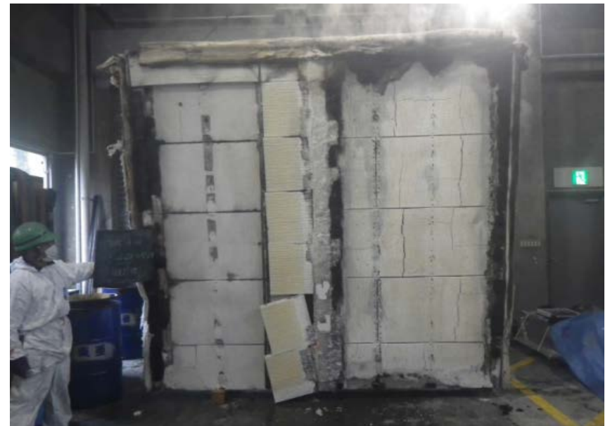
(2)加熱後の試験体の様子
