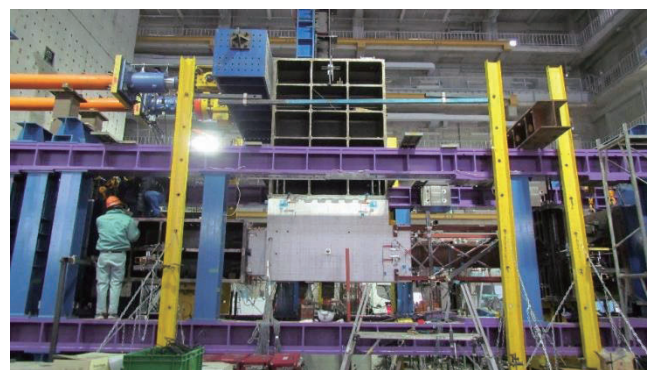
図4 実大杭基礎部分架構 載荷装置
