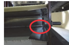
写真 6 ランナーの変形 (Case1)
