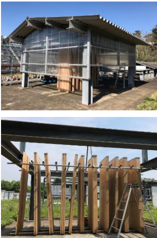
写真1 降雨のない外気曝露環境(上)と屋根なしで雨水が作用する曝露環境(下)
