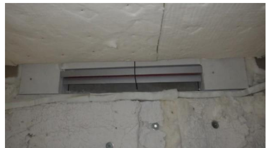
写真10 炉内における試験体下部通気口(加熱前)
