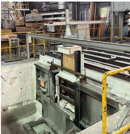
写真9 水平炉の試験体設置状況
