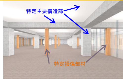
RS、S造梁の変形抑制のための柱
