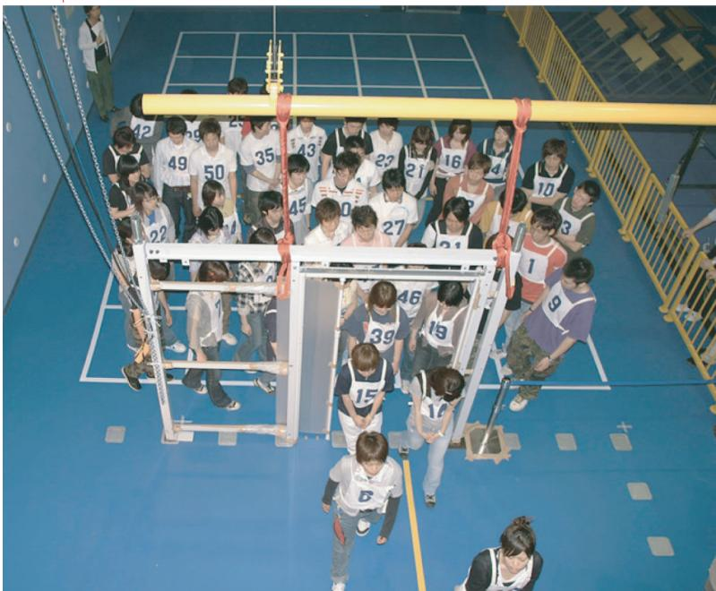
群衆制御を目的とする実験、天井高さなど容積感に関連する実験、日常災害等の中で大きな動作を伴う実験、車いすや歩行動作の実験等、大きな空間規模を必要とする実験を中心に行う場所である。
