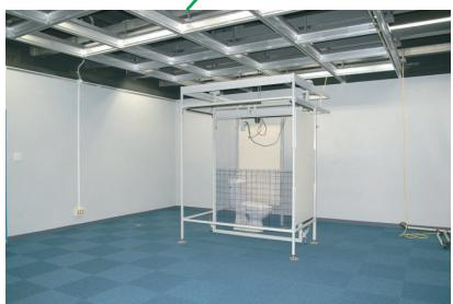
トイレ等の単位空間内での動作の測定、それに伴う空間必要寸法の根拠の算出、手すり等の設置位置の検討の実験を中心に行う場所である。
