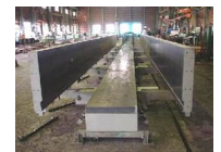
PCa 用型枠（脱型時）
