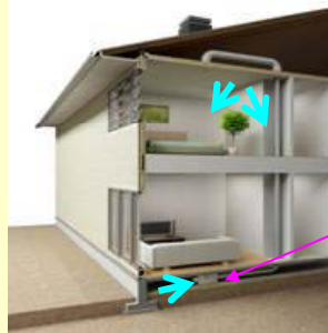
床下へ2階用 涼換気ファン本体設置
