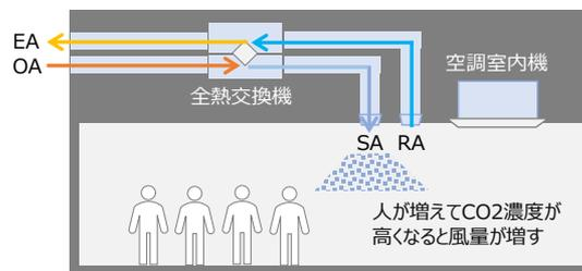
全熱交換機システム・CO2濃度制御イメージ
