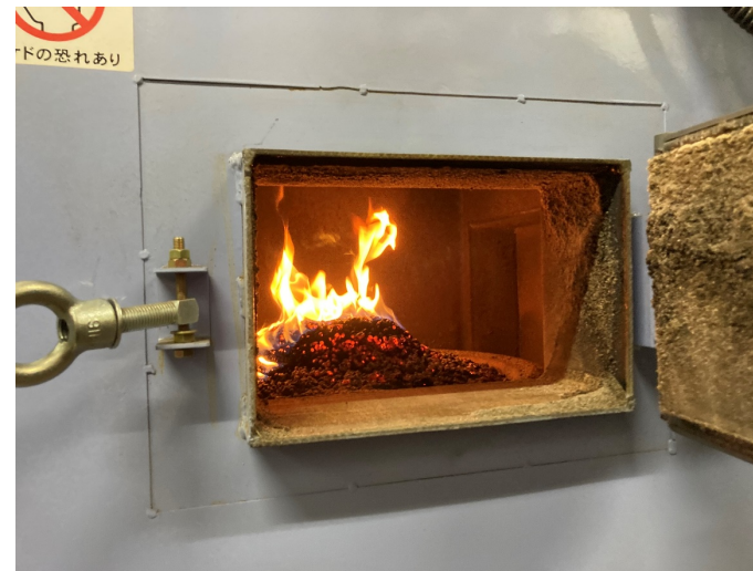
3.ペレット燃焼の様子
